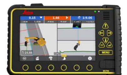
Kääntöpuomilla varustetun kaivinkoneen näyttörüutu
